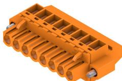
Conectores hembra con conexión brida-tornillo para conexión de conductores con dirección de salida recta (90° o 270°). Los conectores hembra ofrecen espacio para la señalización y se pueden codificar. Sujetado mediante sujeción lateral o pasador de desbloqueo. Disponen también de un tornillo positivo/negativo integrado, protección contra inserción incorrecta del cable y se suministran con bridas-tornillo abiertas. HC = Alta intensidad
