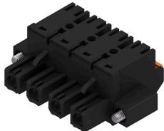
Conector hembra de 180° con conexión PUSH IN para cables de hasta 2,5 mm<sup>2</sup> con un paso de 7,62. Cumple los requerimientos de las normas UL 1059 600 V, clase C, e IEC 61800-5-1. Variantes: sin fijación lateral, con fijación externa o con gancho de fijación.
