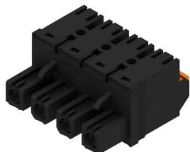
Conector hembra de 180° con conexión PUSH IN para cables de hasta 2,5 mm<sup>2</sup> con un paso de 7,62.
