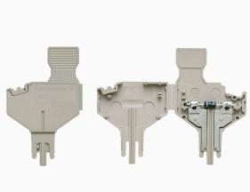
El enchufe para elementos de construcción se utiliza para integrar un componente eléctrico en un bloque de bornes seccionables. Después de soldar el componente electrónico, el conector macho se puede integrar en el área de desconexión de nuestros bloques de bornes seccionables y así cambia la regleta de bornes seccionables en una regleta de bornes modular con componente electrónico integrado.
