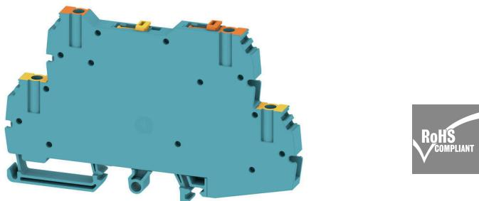
En algunas aplicaciones tiene sentido añadir una toma de prueba o un separador al borne con fines de prueba y seguridad. Los bornes seccionables de medición te permiten medir los circuitos eléctricos libres de tensión. Si bien la distancia de separación y de fuga de los puntos de desconexión no se evalúan en términos dimensionales, debe probarse la sobretensión de choque nominal especificada.
