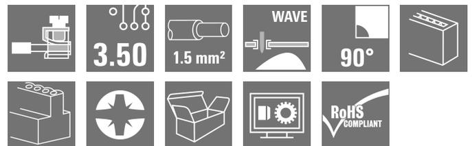
Borne para placas de circuitos impresos compacto y de tamaño reducido con conexión por pisador, paso de 3,5 mm y dirección de salida del conductor de 90°. Idóneo para secciones de conductor de hasta 1,5 mm².
