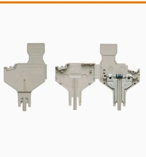
El enchufe para elementos de construcción se utiliza para integrar un componente eléctrico en un bloque de bornes seccionables. Después de soldar el componente electrónico, el conector macho se puede integrar en el área de desconexión de nuestros bloques de bornes seccionables y así cambia la regleta de bornes seccionables en una regleta de bornes modular con componente electrónico integrado.
