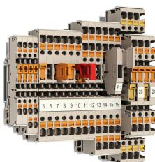
En algunas aplicaciones tiene sentido añadir una toma de prueba o un separador al borne con fines de prueba y seguridad. Los bornes seccionables de medición te permiten medir los circuitos eléctricos libres de tensión. Si bien la distancia de separación y de fuga de los puntos de desconexión no se evalúan en términos dimensionales, debe probarse la sobretensión de choque nominal especificada.
