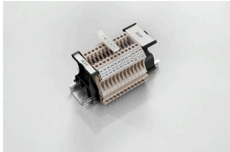
El portaetiquetas para conjuntos <B>SchT 5</B> se enclavará directamente en el carril TS 32 (guía perfil asimétrico) o en el carril TS 35 (guía perfil simétrico). De esta forma la regleta de bornes puede identificarse con una etiqueta independientemente de los bornes incluidos en la regleta.
