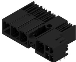
Combinación de conector macho de 90° con contactos de potencia y señal, con conexión PUSH IN, incl. enclavamiento mediante sujeción intermedia con autobloqueo y conexión de apantallamiento insertable (opcional) con un paso de 7,62.
