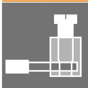
Conecotor M12 con protección IP67 disponible con conexión brida-tornillo o directa.
