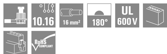
Conector hembra de 180° con un paso de 10,16 para redes de TI. Cumple los requisitos de la norma UL1059 600 V, clase C. En combinación con el conector macho SU 10.16 IT con contacto en avance.
