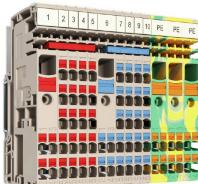
El concepto modular único se puede adaptar a cada tipo de máquina. Los bornes de distribución de potencial AAP tienen un gran éxito gracias a su diseño uniforme con dos construcciones posibles: en alternancia o agrupadas. En la estructura agrupada de la distribución de corriente de control, los potenciales se alojan en diferentes bornes y, por tanto, forman bloques completos de potencial.
