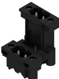
Conecotor macho resistente a altas temperaturas, de doble piso, desplazado lateralmente y cerrado, opcionalmente con brida para soldar. Terminal de soldadura 1,5 mm idónea para utilización de soldadura Reflow. Terminal de soldadura de 3,2 mm idóneo para soldadura Reflow y por ola. Los conectores macho ofrecen espacio para rotulación y se pueden codificar.
