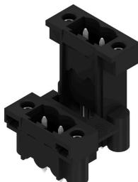
Conecotor macho resistente a altas temperaturas, de doble piso, desplazado lateralmente y cerrado, opcionalmente con brida para soldar. Terminal de soldadura 1,5 mm idónea para utilización de soldadura Reflow. Terminal de soldadura de 3,2 mm idóneo para soldadura Reflow y por ola. Los conectores macho ofrecen espacio para rotulación y se pueden codificar.
