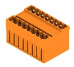
Conector macho de doble piso con cara enchufable paralela. La longitud del terminal de soldadura está optimizada para la utilización de soldadura por ola. Los conectores macho ofrecen espacio para rotulación y se pueden codificar.
