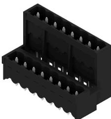
Conector macho resistente a altas temperaturas, de doble piso, desplazado lateralmente y cerrado, opcionalmente con brida para soldar. Terminal de soldadura 1,5 mm idónea para utilización de soldadura Reflow. Terminal de soldadura de 3,2 mm idóneo para soldadura Reflow y por ola. Los conectores macho ofrecen espacio para rotulación y se pueden codificar.
