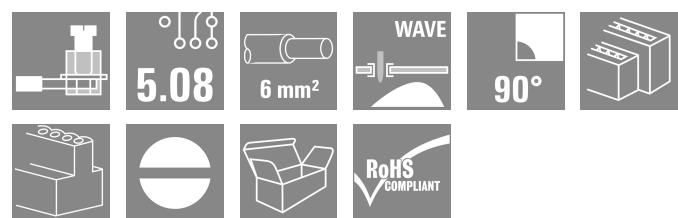
Bornes para placas de circuitos impresos de uno o varios niveles de perfil bajo conexión brida-tornillo probada, pasos de 5,00 mm y 5,08 mm y dirección de salida del conductor de 90°. Idóneo para secciones de conductor de hasta 6,0 mm<sup>2</sup>.
