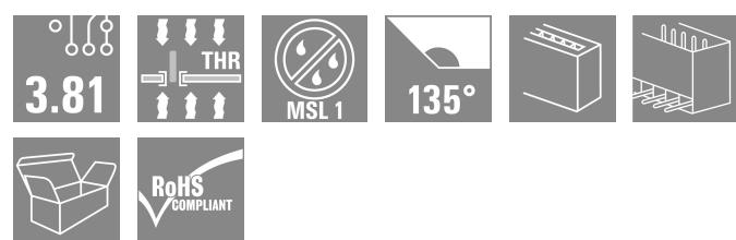
El conector macho resistente a altas temperaturas SC-SMT con dirección de salida a 135°, el ángulo de 135° queda definido por la dirección de inserción y la espiga de soldadura y se corresponde con una dirección de salida oblicua de 45° respecto a la placa de circuito impreso.
