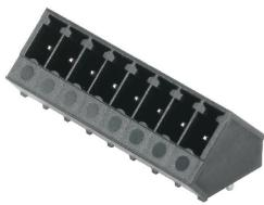
El conector macho resistente a altas temperaturas SC-SMT con dirección de salida a 135°: el ángulo de 135° queda definido por la dirección de inserción y la espiga de soldadura y se corresponde con una dirección de salida oblicua de 45° respecto a la placa de circuito impreso.
