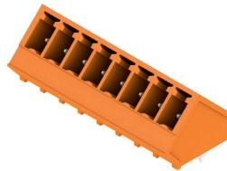
Conectores macho SC con dirección de salida de 135° - el ángulo de 135° se define entre la dirección de inserción y la espiga de soldadura y describe una dirección de salida oblicua de 45° a la placa c.i.
