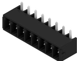
El conector macho resistente a altas temperaturas SC-SMT con dirección de salida de 270°: el ángulo de 270° queda definido por la dirección de inserción y la espiga de soldadura y se corresponde con la dirección de inserción paralela a la placa de circuito impreso, aunque para la inserción de conectores hembra desde la cabeza.
