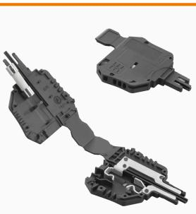
El soporte de fusible SIHA convierte rápidamente un borne seccionable en un borne portafusibles: sólo es necesario retirar la palanca de desconexión e insertar el enchufe con fusible.
