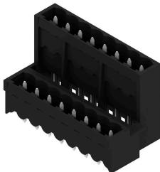
Conecotor macho resistente a altas temperaturas, de doble piso, desplazado lateralmente y cerrado, opcionalmente con brida para soldar. Terminal de soldadura 1,5 mm idónea para utilización de soldadura Reflow. Terminal de soldadura de 3,2 mm idóneo para soldadura Reflow y por ola. Los conectores macho ofrecen espacio para rotulación y se pueden codificar.
