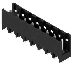
Conector macho abierto, recto y resistente a altas temperaturas. Embalaje en caja o cinta. En cinta, con pin de soldadura de 1,5 mm, optimizado para el montaje automático. Pin de soldadura de 3,2 mm, indicado para soldadura reflow y por ola. Los conectores macho disponen de espacio para señalización y se pueden codificar. HC = Alta intensidad
