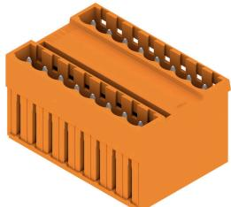
Conejero macho de doble piso con cara enchufable paralela. La longitud del terminal de soldadura está optimizada para la utilización de soldadura por ola. Los conectores macho ofrecen espacio para rotulación y se pueden codificar.
