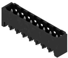
Conector macho resistente a altas temperaturas, embalado en caja o cinta. En cinta, con pin de soldadura de 1,5 mm, optimizado para el montaje automático. Pin de soldadura de 3,2 mm, indicado para soldadura reflow y por ola. Los conectores macho disponen de espacio para señalización y se pueden codificar. HC = Alta intensidad
