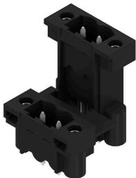
Conector macho resistente a altas temperaturas, de doble piso, desplazado lateralmente y cerrado, opcionalmente con brida para soldar. Terminal de soldadura 1,5 mm idónea para utilización de soldadura Reflow. Terminal de soldadura de 3,2 mm idóneo para soldadura Reflow y por ola. Los conectores macho ofrecen espacio para rotulación y se pueden codificar.
