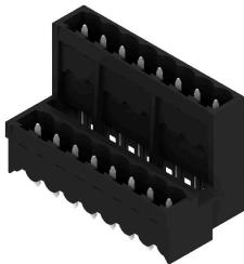
Conecotor macho resistente a altas temperaturas, de doble piso, desplazado lateralmente y cerrado, opcionalmente con brida para soldar. Terminal de soldadura 1,5 mm idónea para utilización de soldadura Reflow. Terminal de soldadura de 3,2 mm idóneo para soldadura Reflow y por ola. Los conectores macho ofrecen espacio para rotulación y se pueden codificar.
