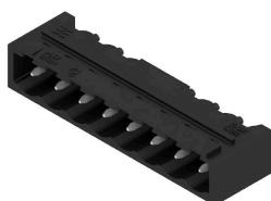
Conector macho resistente a altas temperaturas, embalado en caja o cinta. En cinta, con pin de soldadura de 1,5 mm, optimizado para el montaje automático. Pin de soldadura de 3,2 mm, indicado para soldadura reflow y por ola. Los conectores macho disponen de espacio para señalización y se pueden codificar. HC = Alta intensidad
