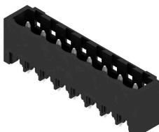
Conector macho resistente a altas temperaturas, embalado en caja o cinta. En cinta, con pin de soldadura de 1,5 mm, optimizado para el montaje automático. Pin de soldadura de 3,2 mm, indicado para soldadura reflow y por ola. Los conectores macho disponen de espacio para señalización y se pueden codificar. HC = Alta intensidad
