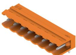
Conectores macho con dirección de salida 90°. La longitud del terminal de soldadura está optimizada para la utilización de soldadura por ola. Los conectores macho ofrecen espacio para rotulación y se pueden codificar.
