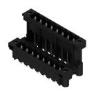
Conector macho resistente a altas temperaturas, de doble piso, desplazado lateralmente con brida o brida para soldadura. Terminal de soldadura de 1,5 mm idóneo para aplicaciones de soldadura reflow. Terminal de soldadura de 3,2 mm idóneo para soldadura Reflow y por ola. Los conectores macho ofrecen espacio para rotulación y se pueden codificar.
