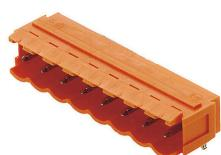
Conectores macho con dirección de salida 90°. La longitud del terminal de soldadura está optimizada para la utilización de soldadura por ola. Los conectores macho ofrecen espacio para rotulación y se pueden codificar.
