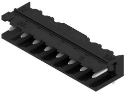
Conector macho resistente a altas temperaturas, acodado 90°, abierto. Embalaje en caja o cinta. En cinta, con pin de soldadura de 1,5 mm, optimizado para el montaje automático. Pin de soldadura de 3,2 mm, indicado para soldadura reflow y por ola. Los conectores macho disponen de espacio para señalización y se pueden codificar. HC = Alta intensidad
