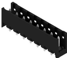
Conejero macho abierto, recto y resistente a altas temperaturas. Embalaje en caja o cinta. En cinta, con pin de soldadura de 1,5 mm, optimizado para el montaje automático. Pin de soldadura de 3,2 mm, indicado para soldadura reflow y por ola. Los conectores macho disponen de espacio para señalización y se pueden codificar. HC = Alta intensidad
