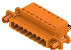
Conejero macho con conexión PUSH IN y dirección de salida recta; se usa junto con BLF 5.08HC en la aplicación "wire-to-wire" como pasamuros. Los conectores macho disponen de espacio para rotulación y se pueden codificar.
