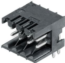
Conector macho resistente a altas temperaturas, recto, de dos hileras, para todos los procesos de soldadura de uso corriente. Optimizado para el montaje automático. Presentados en caja o cinta. Los conectores macho ofrecen espacio para rotulación y se pueden codificar. (Embalaje con cinta, bajo pedido)
