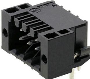
Conector macho resistente a altas temperaturas, recto, de dos hileras, para todos los procesos de soldadura de uso corriente. Optimizado para el montaje automático. Presentados en caja o cinta. Los conectores macho ofrecen espacio para rotulación y se pueden codificar.
