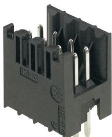
Conecotor macho resistente a altas temperaturas, de dos filas, para todos los procesos de soldadura de uso corriente. Optimizado para el montaje automático. Embalaje en caja o cinta. Pin de soldadura de 3,2 mm indicado para soldadura reflow y por ola. Los conectores macho ofrecen espacio para la señalización y se pueden codificar.
