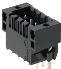
Conector macho resistente a altas temperaturas, de dos filas, para todos los procesos de soldadura de uso corriente. Optimizado para el montaje automático. Embalaje en caja o cinta. Pin de soldadura de 3,2 mm indicado para soldadura reflow y por ola. Los conectores macho ofrecen espacio para la señalización y se pueden codificar.
