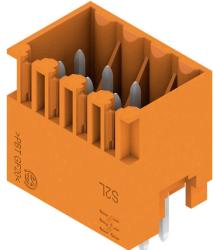
Conejero macho de dos filas disponible con lateral cerrado o con sujeción lateral (conectores macho con lateral abierto, bajo demanda). Los conectores macho con una longitud de pin superior a 3,5 mm están diseñados para soldadura por ola y se presentan embalados en caja. Se pueden atornillar sobre la placa de circuito impreso. Los conectores macho disponen de espacio para señalización y codificación.
