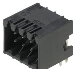
Conector macho resistente a altas temperaturas, recto, de dos hileras, para todos los procesos de soldadura de uso corriente. Optimizado para el montaje automático. Presentados en caja o cinta. Los conectores macho ofrecen espacio para rotulación y se pueden codificar.
