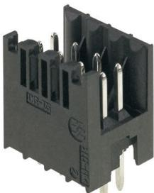
Conector macho resistente a altas temperaturas, de dos filas, para todos los procesos de soldadura de uso corriente. Optimizado para el montaje automático. Embalaje en caja o cinta. Pin de soldadura de 3,2 mm indicado para soldadura reflow y por ola. Los conectores macho ofrecen espacio para la señalización y se pueden codificar.
