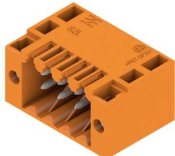
Conecotores macho acodados de dos filas en las variantes con lateral cerrado o con brida (conectores macho con lateral abierto, bajo pedido). Los conectores macho con terminal de 3,5 mm están diseñados para soldadura por ola y se presentan empaquetados en caja. Se puede atornillar en la placa c.i. Los conectores macho ofrecen espacio para rotulación y se pueden codificar.
