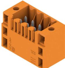
Conejor macho de dos filas disponible con lateral cerrado o con sujeción lateral (conectores macho con lateral abierto, bajo demanda). Los conectores macho con una longitud de pin superior a 3,5 mm están diseñados para soldadura por ola y se presentan embalados en caja. Se pueden atornillar sobre la placa de circuito impreso. Los conectores macho disponen de espacio para señalización y codificación.
