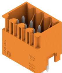
Conecotor macho de dos filas disponible con lateral cerrado o con sujeción lateral (conecktores macho con lateral abierto, bajo demanda). Los conectores macho con una longitud de pin superior a 3,5 mm están diseñados para soldadura por ola y se presentan empaquetados en caja. Se pueden atornillar sobre la placa de circuito impreso. Los conectores macho disponen de espacio para señalización y codificación.
