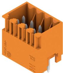
Conector macho de dos filas disponible con lateral cerrado o con sujeción lateral (conectores macho con lateral abierto, bajo demanda). Los conectores macho con una longitud de pin superior a 3,5 mm están diseñados para soldadura por ola y se presentan embalados en caja. Se pueden atornillar sobre la placa de circuito impreso. Los conectores macho disponen de espacio para señalización y codificación.
