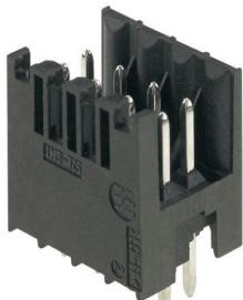
Conector macho resistente a altas temperaturas, de dos filas, para todos los procesos de soldadura de uso corriente. Optimizado para el montaje automático. Embalaje en caja o cinta. Pin de soldadura de 3,2 mm indicado para soldadura reflow y por ola. Los conectores macho ofrecen espacio para la señalización y se pueden codificar.
