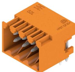
Conectores macho acodados de dos filas en las variantes con lateral cerrado o con brida (conectores macho con lateral abierto, bajo pedido). Los conectores macho con terminal de 3,5 mm están diseñados para soldadura por ola y se presentan empaquetados en caja. Se puede atornillar en la placa c.i. Los conectores macho ofrecen espacio para rotulación y se pueden codificar.
