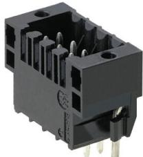
Conecotor macho resistente a altas temperaturas, de dos filas, para todos los procesos de soldadura de uso corriente. Optimizado para el montaje automático. Embalaje en caja o cinta. Pin de soldadura de 3,2 mm indicado para soldadura reflow y por ola. Los conectores macho ofrecen espacio para la señalización y se pueden codificar.
