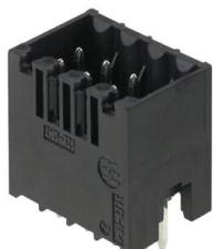
Conector macho resistente a altas temperaturas, de dos filas, para todos los procesos de soldadura de uso corriente. Optimizado para el montaje automático. Embalaje en caja o cinta. Pin de soldadura de 3,2 mm indicado para soldadura reflow y por ola. Los conectores macho ofrecen espacio para la señalización y se pueden codificar.
