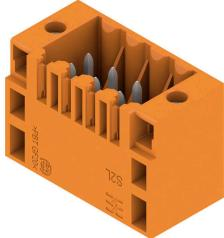
Conector macho de dos filas disponible con lateral cerrado o con sujeción lateral (conectores macho con lateral abierto, bajo demanda). Los conectores macho con una longitud de pin superior a 3,5 mm están diseñados para soldadura por ola y se presentan embalados en caja. Se pueden atornillar sobre la placa de circuito impreso. Los conectores macho disponen de espacio para señalización y codificación.
