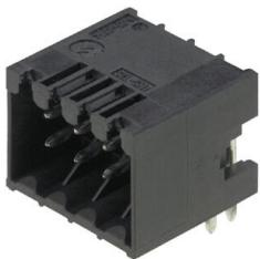
Conector macho resistente a altas temperaturas, recto, de dos hileras, para todos los procesos de soldadura de uso corriente. Optimizado para el montaje automático. Presentados en caja o cinta. Los conectores macho ofrecen espacio para rotulación y se pueden codificar.
