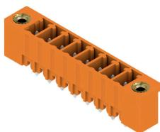
El conector macho SC permite la dirección de inserción perpendicular respecto a la placa de circuito impreso (vertical) y está disponible en la variante cerrada (G) y con brida-tornillo (F). Los conectores de Weidmüller con paso de 3,81 mm (0,15 pulgadas) son compatibles con los conectores convencionales y ofrecen espacio para la impresión y codificación.
