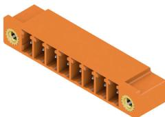
El conector macho SC permite la dirección de inserción paralela respecto a la placa de circuito impreso (horizontal) y está disponible en la variante cerrada (G) y con brida-tornillo (F). Los conectores de Weidmüller con paso de 3,81 mm (0,15 pulgadas) son compatibles con los conectores convencionales y ofrecen espacio para la impresión y codificación, así como un alojamiento para indicadores luminosos.
