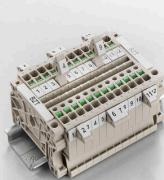
El soporte para señalizadores ofrece la posibilidad de montar adicionalmente señalizadores estándar con un paso de 5 ó 5,1 mm. Los soportes acodados se pueden encajar opcionalmente y se pueden montar en todos los canales de señalización estándar de los bornes modulares Klippon® Connect. Los tipos de señalizadores de ajuste se pueden encontrar en los respectivos accesorios del soporte de señalización.
