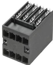
Conectores macho de doble fila, alta intensidad y alto rendimiento, con o sin sujeción, para bloqueo rápido sin herramientas. Optimizado para "módulos tamaño libre" de mín. 50 mm de ancho. Con opción integrada para montaje pasamuros. Fiabilidad excepcional y seguridad operativa gracias al perfil de conexión 100% a prueba de fallos, codificación única y sujeción opcional por tornillo.
