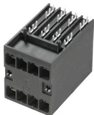
Conectores macho de doble fila, alta intensidad y alto rendimiento, con o sin sujeción, para bloqueo rápido sin herramientas. Optimizado para "módulos tamaño libro" de mín. 50 mm de ancho. Con opción integrada para montaje pasamuros. Fiabilidad excepcional y seguridad operativa gracias al perfil de conexión 100% a prueba de fallos, codificación única y sujeción opcional por tornillo.
