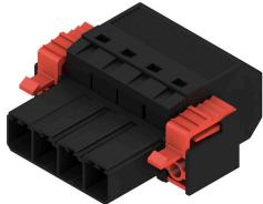
Conector macho invertido con conexión PUSH IN con sujeción externa invertida, de hasta 6 mm<sup>2</sup>, con un paso de 7,62. También ideal como solución con protección frente al contacto con los dedos para tensiones inversas. Cumple los requerimientos de las normas UL 1059 600 V, clase C, e IEC 61800-5-1. Opcionalmente, también disponible en versión atornillable y sin sujeción lateral.
