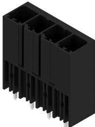
Conector macho de alto rendimiento, de una hilera, para montaje en serie sin pérdida de polos o con sujeción patentada para enclavamiento rápido sin herramientas. La mejor fiabilidad de maniobra y funcionamiento gracias a una cara enchufable que impide errores de conexión, con diversidad de codificación única y sujeción adicional. La longitud del pin de 3,5 mm está optimizada para soldadura por ola sin plomo.
