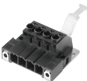
Conector macho de alto rendimiento con la reconocida conexión brida-tornillo de acero y totalmente exenta de mantenimiento de Weidmüller. Montaje en serie sin pérdida de polos o con sujeción multifunción patentada para un enclavamiento seguro, rápido y sin herramientas. La mejor fiabilidad de maniobra y funcionamiento gracias a una cara enchufable que impide errores de conexión, con diversidad de codificación única, protección contra cableado erróneo. Apto para señalización.
